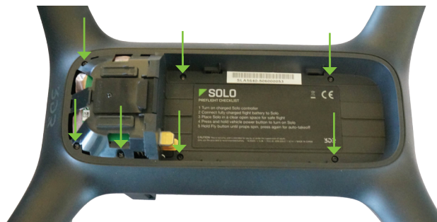
Figura 9.5.2.1: Retirar la bandeja de la batería
