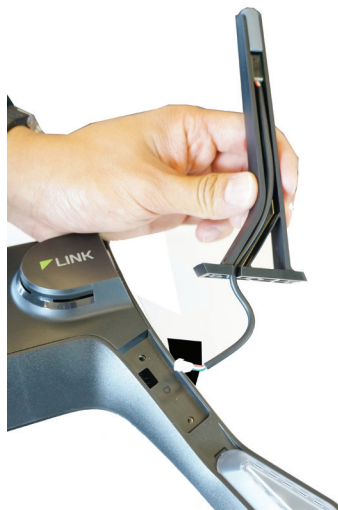
Figura 9.4.3.2: Insertar una pata nueva con brújula
