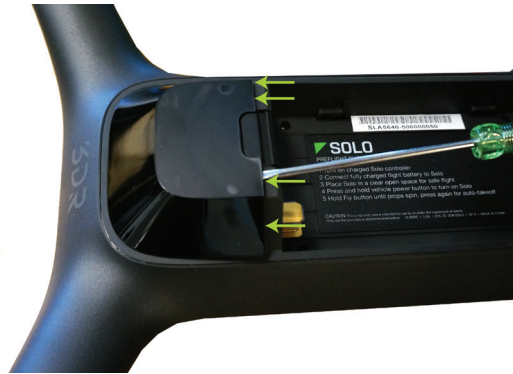
Figura 9.5.1.1: Retirar la cubierta del GPS
