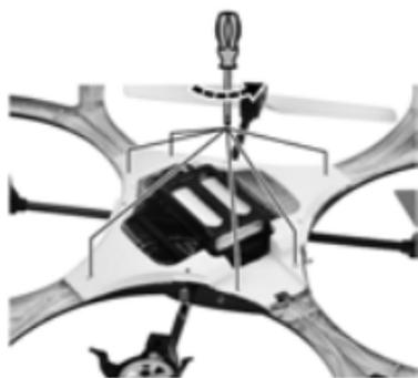
2. Retire la carcasa del AIRIS DR004 y enchufe el conector de la cámara en la placa base.
