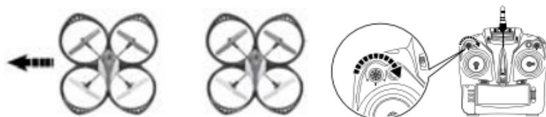
4. Cuando el ARIS DR004 se mueve sólo hacia la derecha, ajuste la estabilización en la ruleta de estabilización correspondiente en la esquina superior izquierda del transmisor, girándolo hacia la izquierda, como se muestra a continuación.
